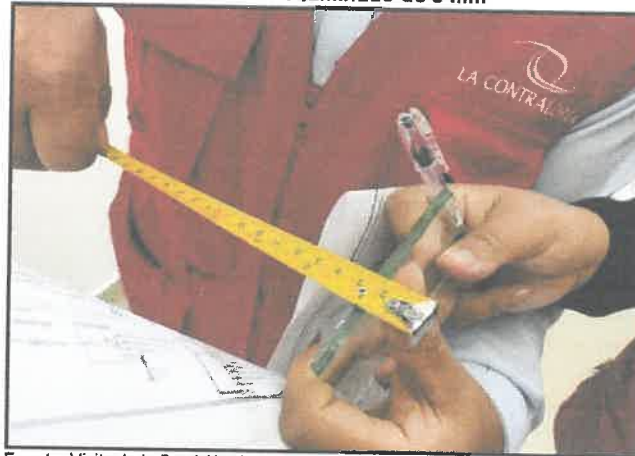
Imagen n.º 19 Vidrio instalado corresponde a “vidrio crudo laminado de 5 mm”
